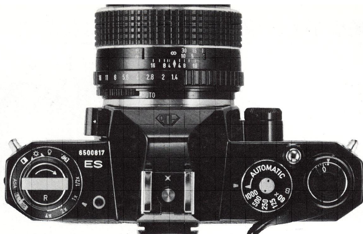
Pentax ES'eren set oppefra. Filmhastigheden sættes ved tilbagespolingsknappen, hvor der også er markering for s/h eller farvefilm (kunstlys og dagslys). Foran th. ved siden af objektivet anbringes batteriet.
